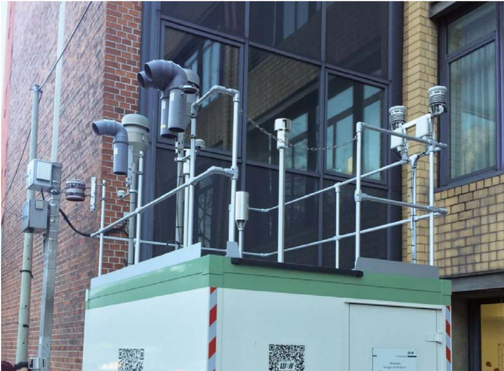
**Abbildung 2.1:** Messeinrichtung zur Kontrolle der Luftqualität – hier am Stuttgarter Neckartor (Foto: A. Dittler).
